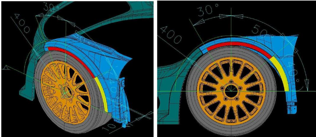
Mērījums tiek veikts ar 400mm garu mērinstrumentu.
